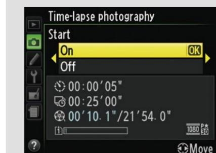
Запись цейтраферного видеоролика со стандартным интервалом в 5 с и продолжительностью съемки 25 мин.
