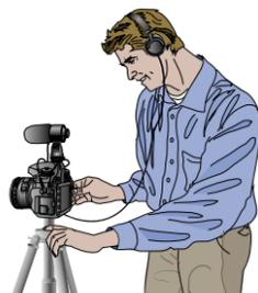
Регулировка чувствительности микрофона поддерживается даже в режиме live view для видеороликов, с использованием стереонаушников и при отображении индикаторов уровня звука.
