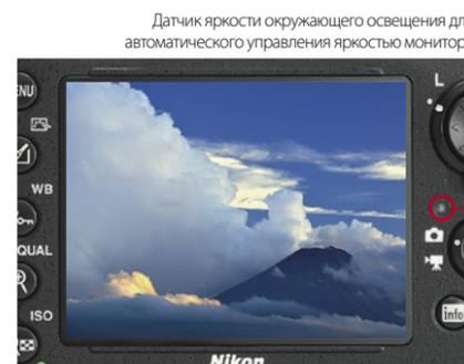
Датчик яркости окружающего освещения для автоматического управления яркостью монитора
