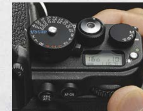
При установке шага 1/3 можно управлять выдержкой с помощью главного диска управления, не отрывая взгляда от видоискателя
