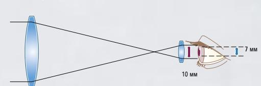
Диаметр зрачка бинокля, равный 10 мм, и диаметр зрачка человеческого глаза, равный 7 мм
