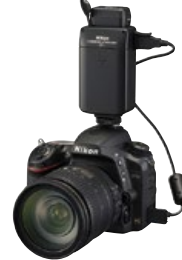
Устройства UT-1 и WT-5A/B/C/D, присоединенные к фотокамере D750
